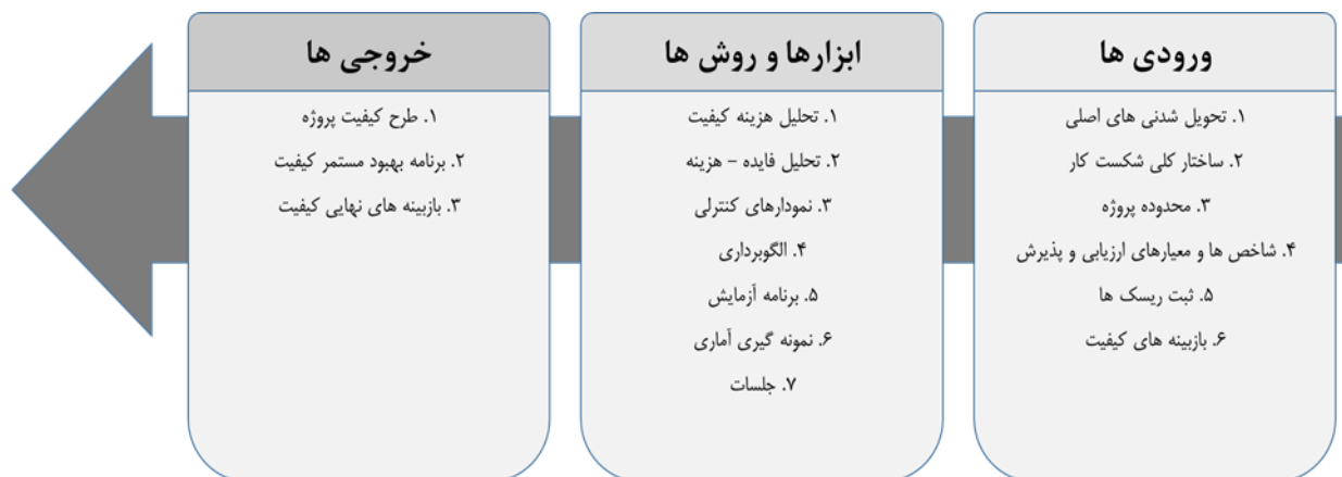
شکل ۲: ورودی ها، ابزار و روش ها و خروجی های برنامه ریزی کیفیت
