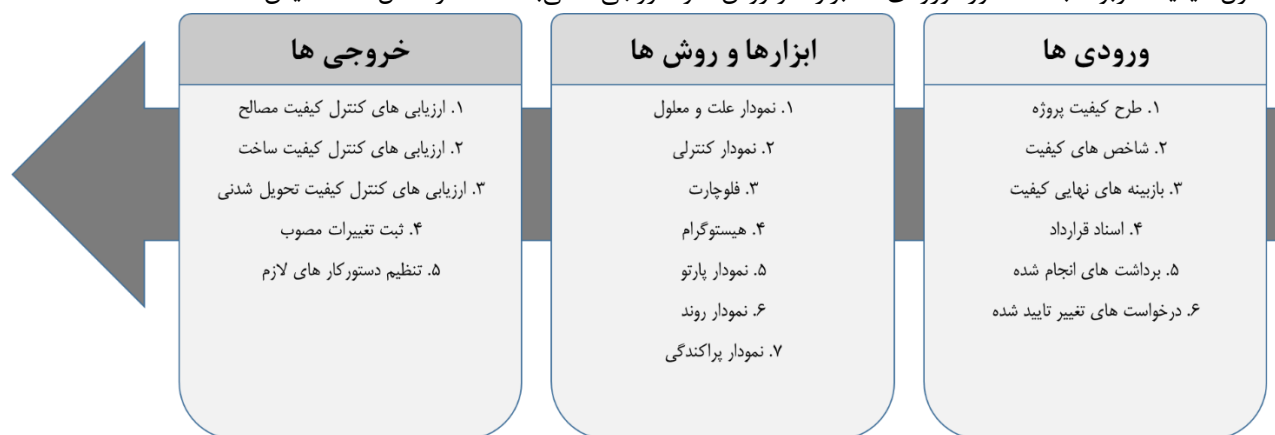
شکل ۴: ورودی‌ها، ابزار و روش‌ها و خروجی‌های کنترل کیفیت
