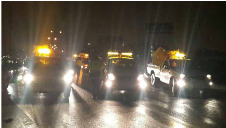
شکل ۳-۱: چیدمان موازی خودروهای انسداد در لحظات اولیه بستن دهانه شمال به جنوب تونل توحید
