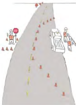
شکل ۸-۱: محل شماتیک توقف پرچم زن به منظور هدایت ترافیکی در بیرون از خطوط عبوری (تک پرچم زن)
