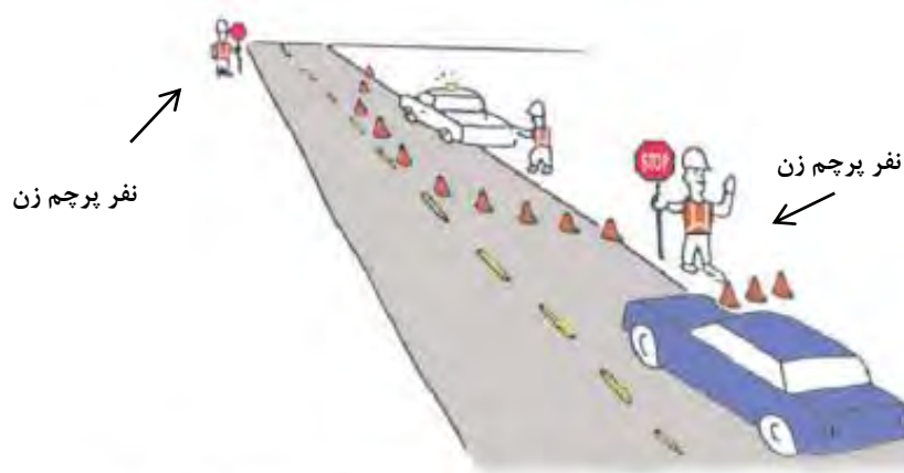
شکل ۷-۱: محل شماتیک توقف پرچم‌زن‌ها به منظور هدایت ترافیکی در بیرون از خطوط عبوری (دو پرچم زن)
