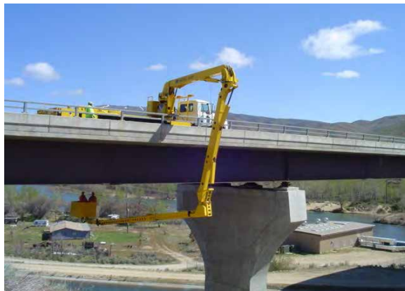
شکل ۶-۱۷: تراک با بازوی بلند برای دسترسی به دیوار خارجی دیوار صوتی و زیر پل
