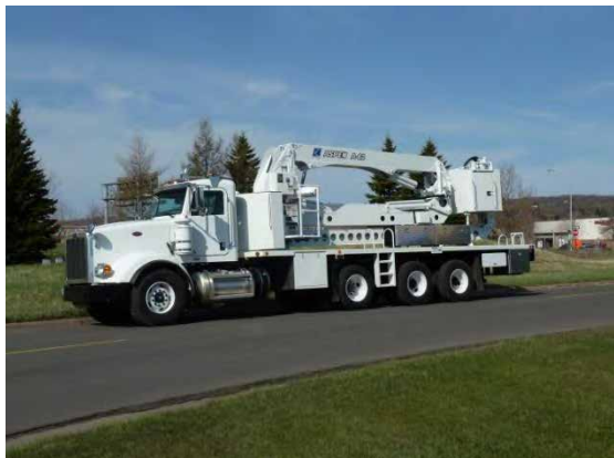
شکل ۶-۱۷: تراک با بازوی بلند برای دسترسی به دیوار خارجی دیوار صوتی و زیر پل
