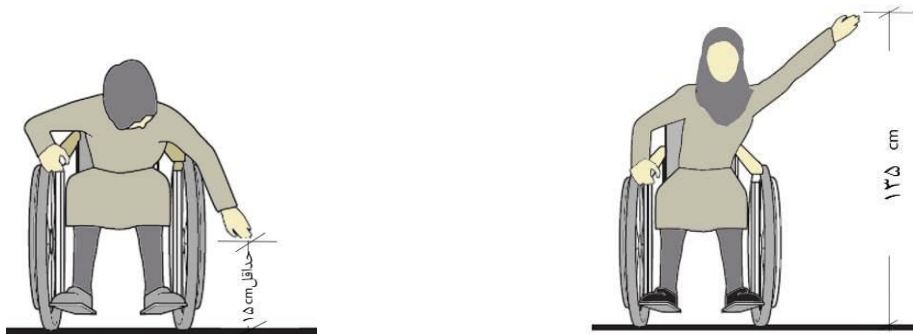
شکل ۱-۱۴: حداقل ارتفاع دسترسی زن دارای معلولیت در حرکت به پایین از پهلو بدون مانع
