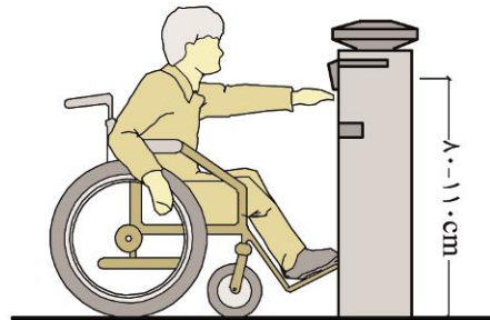
شکل ۲-۱۵۸: ارتفاع شکاف صندوق پست دسترس پذیر
