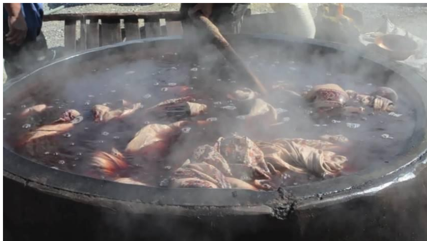
شکل ۱۰- پاتیل رنگرزی ماده آلیزارین، سولفات آهن (زاج سیاه) و سولفات آلومینیم (زاج سفید)
