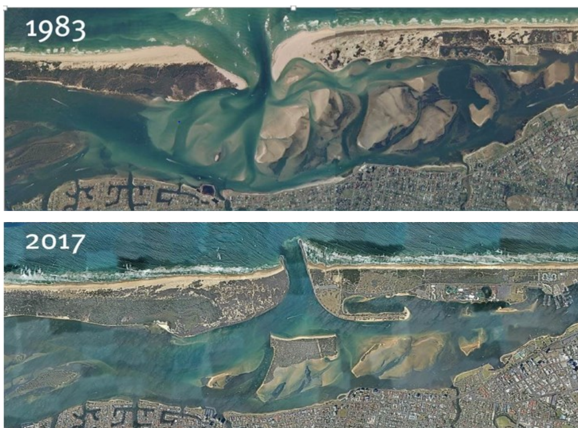
شکل ۲-۱۲- تغییرات خط ساحل و توپوگرافی داخل حوضچه پس از راه اندازی سیستم گذردهی رسوب رودخانه نرنگ
