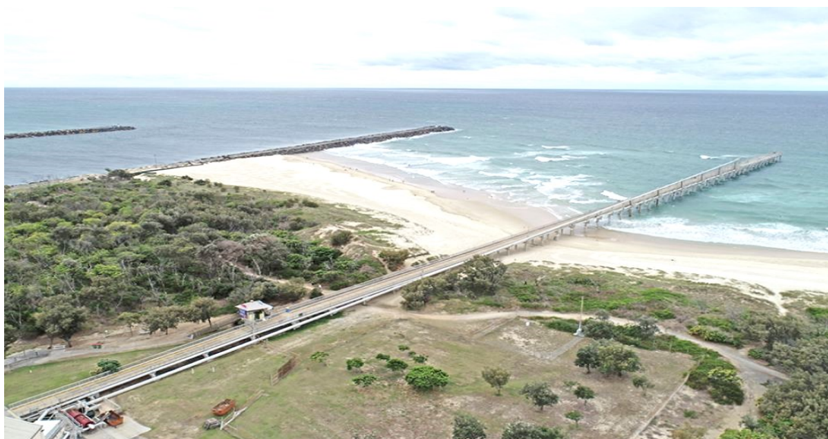
شکل ۲-۹- ورودی رودخانه نرنگ و موقعیت سکو برداشت رسوبات سیستم گذردهی رسوب رودخانه نرنگ
