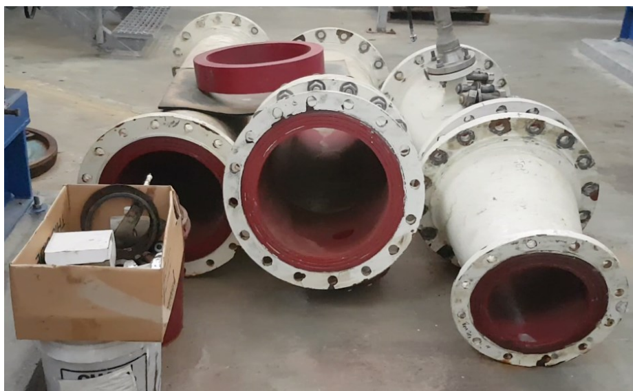
شکل ۱-۵- لوله‌های فولادی با پوشش داخلی پلی اورتان بکار رفته در سیستم گذردهی رسوب رودخانه توفید
