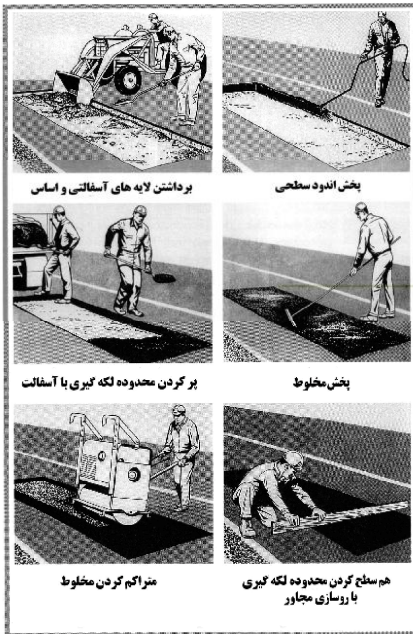
شکل ۳-۷- مراحل لکه‌گیری به روش وصله عمقی
