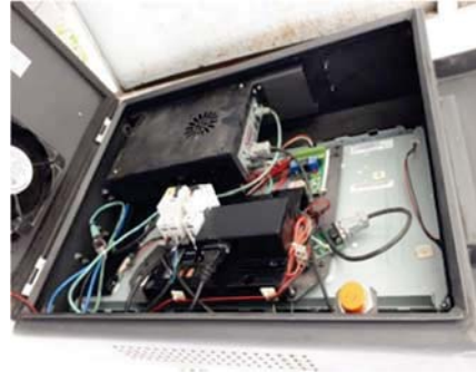
شکل ۴-۵: نصب مجدد تجهیزات داخلی نمایشگر
