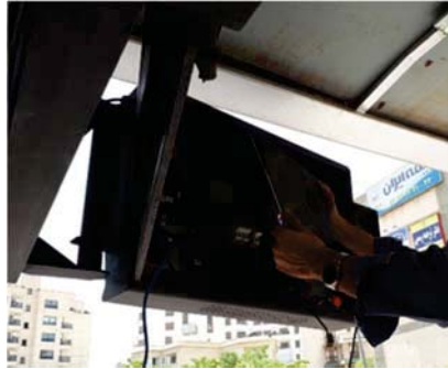
شکل ۴-۵: نصب مجدد تجهیزات داخلی نمایشگر
