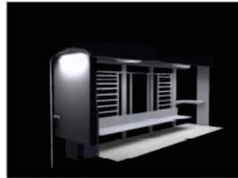
شکل ج ۴-۱۸: شبیه‌سازی طراحی روشنایی یک ایستگاه
