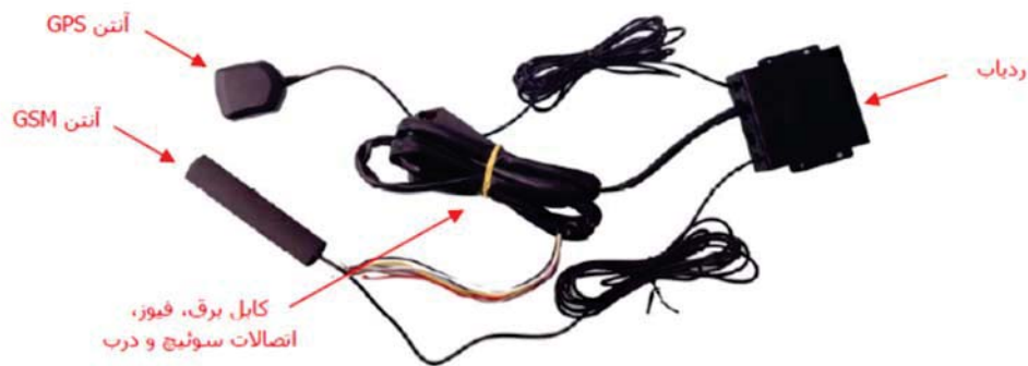
شکل أ۴-۷: قسمت‌های مختلف دستگاه ردیاب GPS
