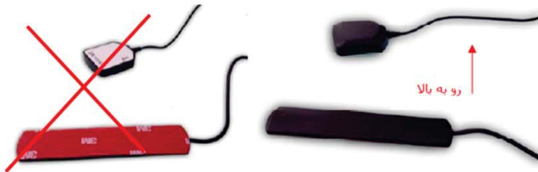
شکل ۴-۱۰: روش صحیح نصب آنتن‌ها که به صورت رو به بالا در زیر داشبورد است
