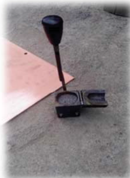
قالب گرافیتی cadweld سیم به صفحه مسی
