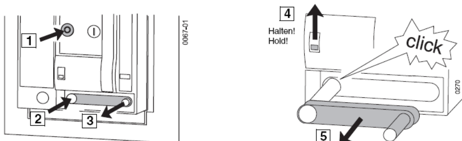
شکل ۲۶- نحوه تست کردن تابلوهای ACB
