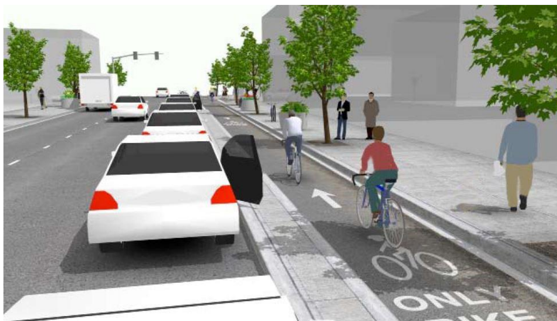
شکل ۱-۴- نمونه جانمایی مسیر درجه ۱ بین خط پارک حاشیه‌ای و جدول
