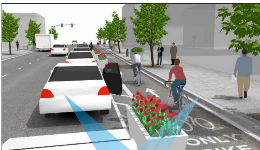
شکل ۴-۵- جداسازی مسیر درجه ۱ از سواره‌رو با استفاده از گلدان
