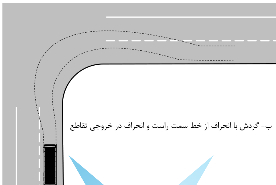
شکل ۳-۱۰- حالت‌های گردش وسایل نقلیه سنگین در قوس تند گوشه تقاطع‌های شهری
