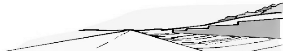
نگاره ۴۶: کاهش تدریجی ارتفاع دیوار بصورت پلکانی
