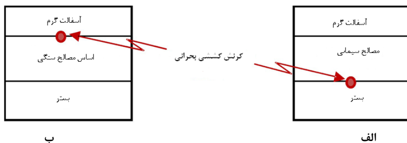
شکل ۲۲-۱- موقعیت کرنش کششی بحرانی در روسازی‌های ترکیبی و انعطاف‌پذیر (الف - روسازی ترکیبی، ب - روسازی انعطاف‌پذیر)
