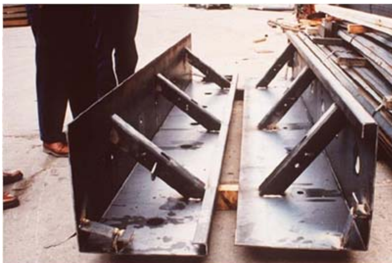
شکل ۳-۲۸- قالب‌های فلزی برای اجرای روسازی با قالب ثابت
