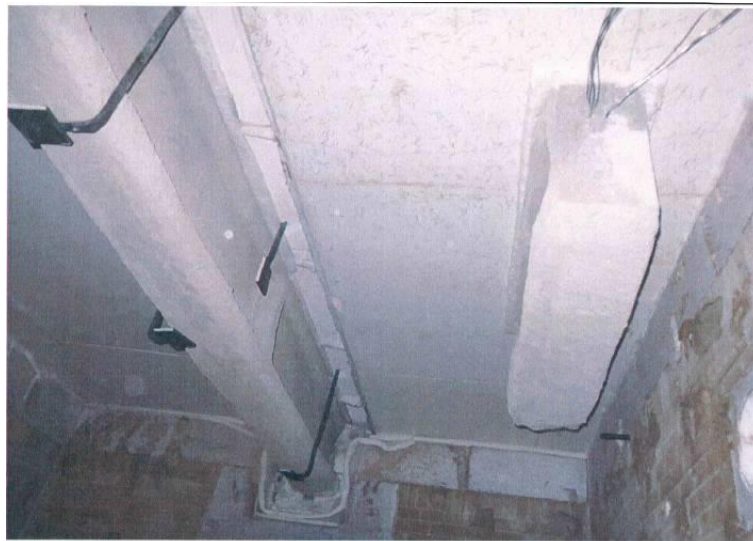
شکل ۴-۴- آزمون حریق همزمان دو تیر فولادی محافظت شده در دو حالت با و بدون بار
