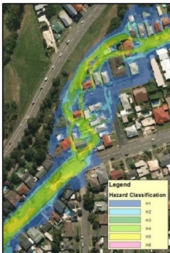
شکل ۲-۸- نمونه‌ای از نقشه پهنه‌بندی خطر سیل بر اساس استاندارد کشور استرالیا [۵۱]
