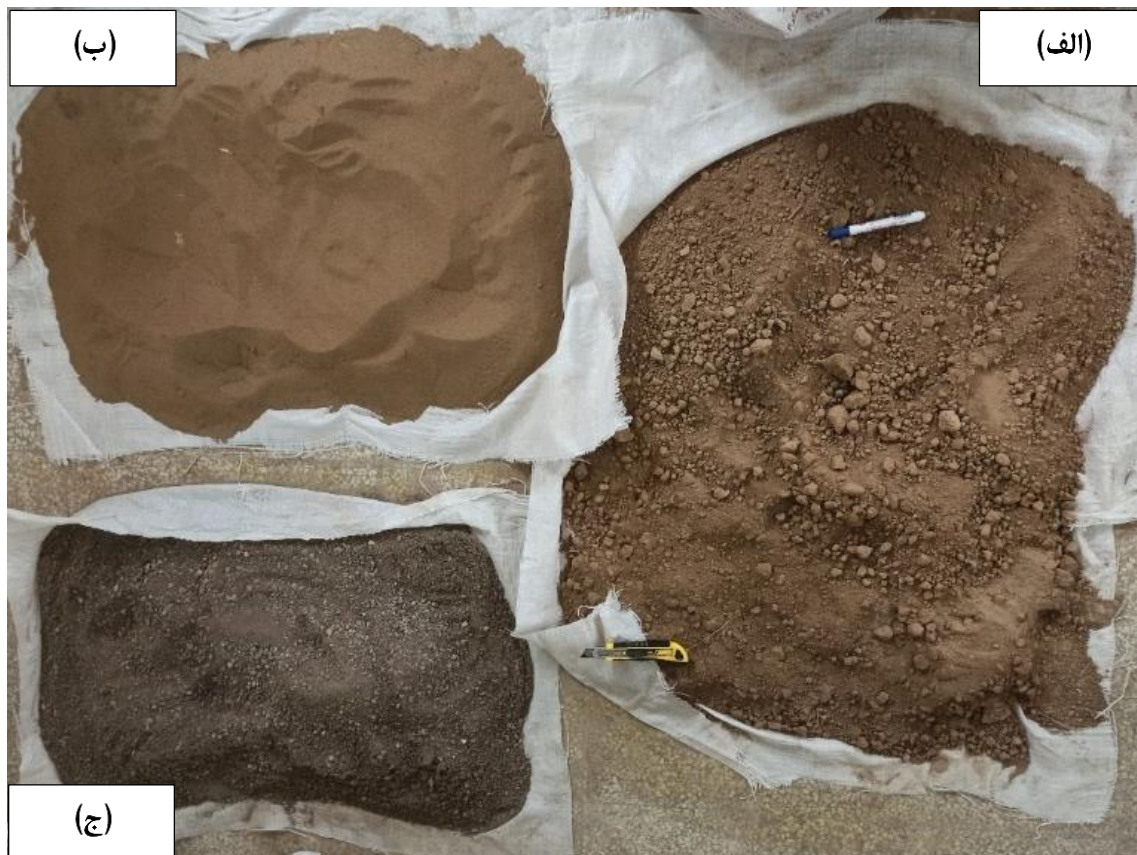
شکل ۱۰-۲ تصویری از نمونه‌های (الف) رسی؛ (ب) ماسه بادی و (ج) ماسه رودخانه‌ای آماده شده در آزمایشگاه
