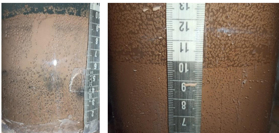
شکل ۱۰-۱۴ وجود تخلخل زیاد، تصویر سمت راست روز اول و تصویر سمت چپ بعد از گذشت ۷ روز در نمونه ۶۰ درصد ماسه و رس
