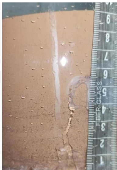
شکل ۷-۱۰ جدا شدن بین رس و ماسه در اثر ته‌نشست آنها داخل لوله شفاف در روش اول بارش برای نمونه شماره ۴ (نمونه حاوی ۵۰ درصد رس و ۵۰ درصد ماسه)
