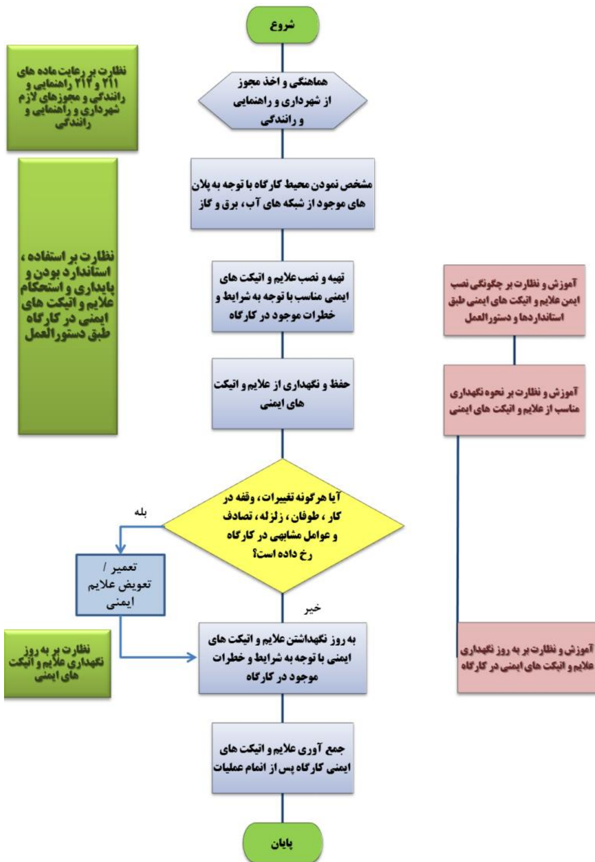
شکل ۸-۱- نمودار کنترل ترافیک در عملیات
