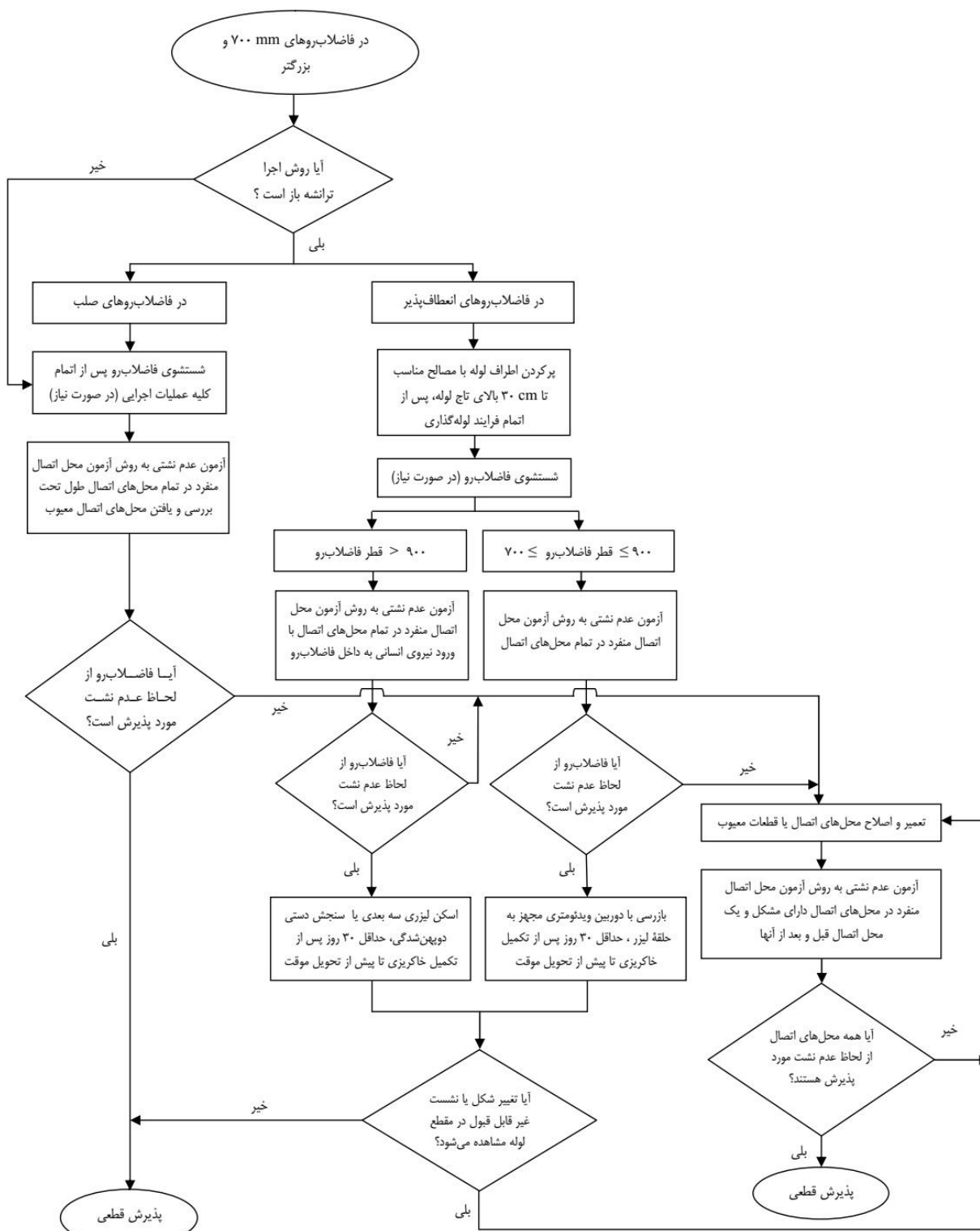
شکل ۷-۲- نمودار جریان مربوط به نحوه آزمون عدم نشستی برای فاضلاب‌روهای با قطر اسمی ۷۰۰ mm و بزرگ‌تر
