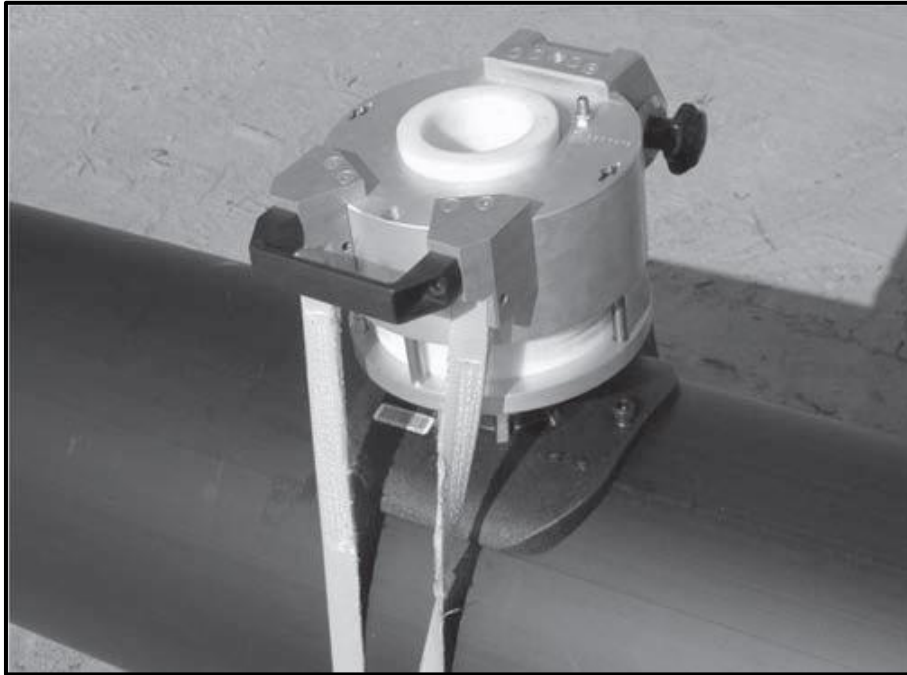
شکل ۸-۵- نمونه‌ای از وصله الکتروفیوژن
