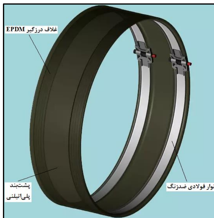
شکل ۵-۱۰- نمونه‌ای از غلاف داخلی برای تعمیر
