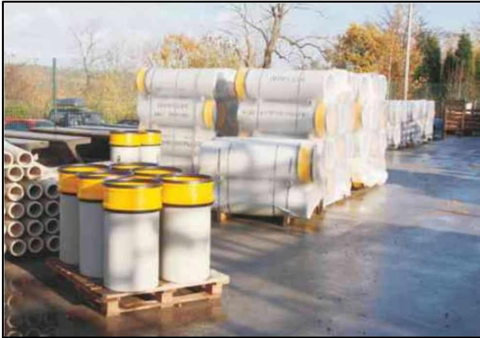
شکل ۲-۳۲- انبارش لوله‌ها به صورت دسته‌ای روی پالت
