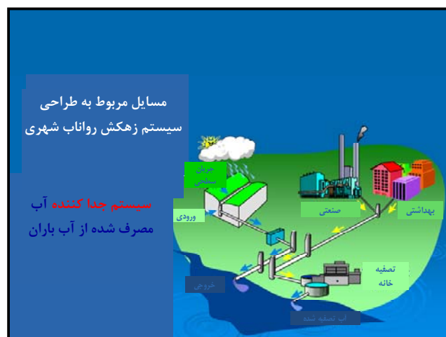
شکل ۳-۸- سیستم مجزای شبکه فاضلاب و آب‌های سطحی
