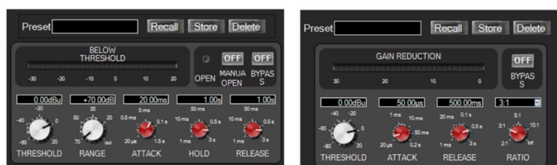
شکل ۷-۵۶- الف- نمونه نرم‌افزار کنترل اکسپندر گیت دیجیتال
