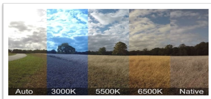
شکل ۳-۲۲- تنظیم خودکار سطح سفیدی در دوربین‌های رنگی
