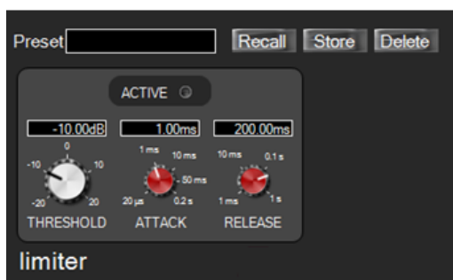
شکل ۷-۵۰ - نمونه کنترل نرم‌افزاری محدودکننده دیجیتال
