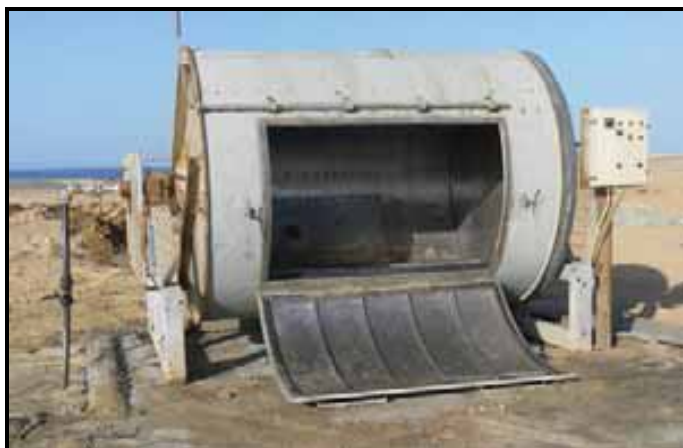
شکل ۳-۱۱- ماشین بزرگ شستشوی تور (با عرض ۴ متر و ارتفاع ۲/۵ متر). واحد موتور و کانکتور فاضلاب به ترتیب در سمت راست و چپ تجهیزات قابل مشاهده هستند.
