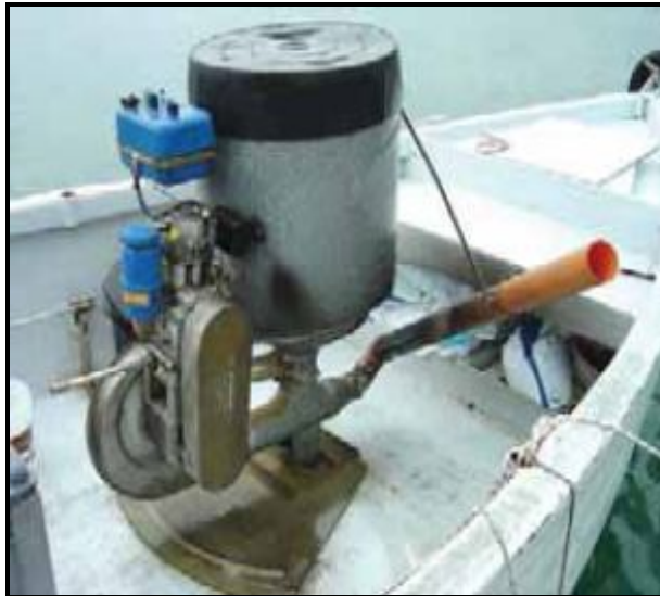
شکل ۳-۲۱- غذاده لوله‌ای در پرورش ماهی در قفس شناور
