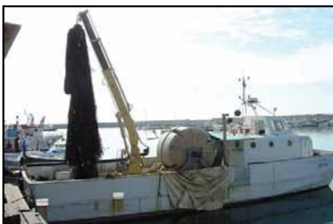
شکل ۳-۱۳- به علت وزن تورها، استفاده از تجهیزات بالابر (نظیر جرثقیل) برای تکان دادن تورها ضروری است. ماشین شستشو با یک موتور هیدرولیک کار می‌کند که به سیستم محرک هیدرولیک وسیله نقلیه متصل است که جرثقیل را نیز به کار می‌اندازد.
