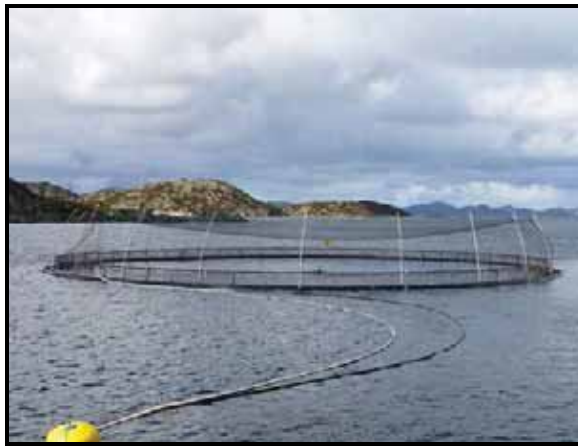
شکل ۳-۳۵- تور ضد پرنده که با میله از سطح آب بیرون نگه داشته شده است.
