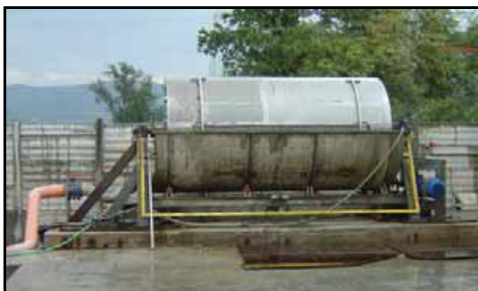
شکل ۳-۱۲- دریچه روی این سمت استوانه بزرگ قرار دارد. بنابراین، انتقال تور را به داخل و خارج از استوانه آسان می‌سازد.
