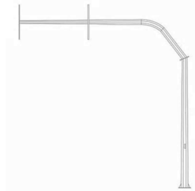
شکل ۷-۱-۱: نمای شماتیک دکل‌های بازودار
