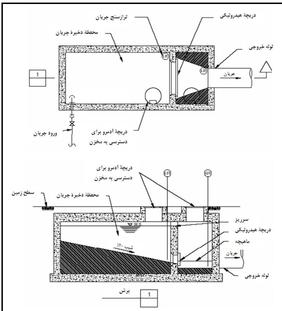
شکل ۶-۴- نمایی از سیستم هایدروسلف [۹۵]
