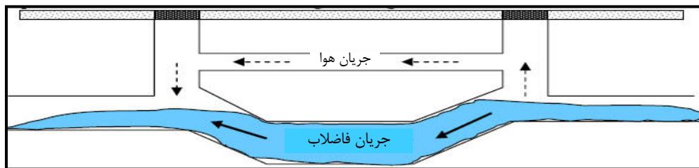
شکل ۲-۶- تعییه لوله کمکی در بالای سیفون [۳۰]
