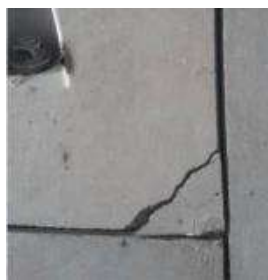
شکستگی گوشه سگمنت کلید حین جا زدن
