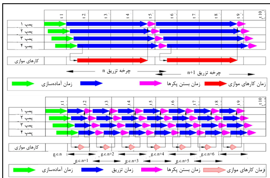
شکل ۶-۲- نمایش شماتیک فرآیند زمانی تزریقات سازه‌ای پوشش تونل
