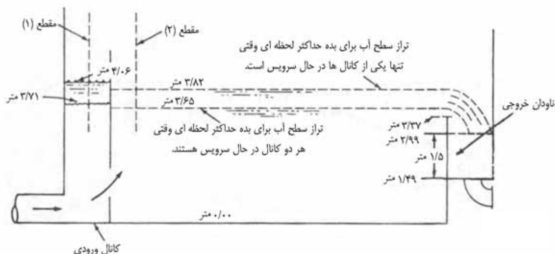
شکل الف-۷- مقطع کانال دانه گیر با نمایش سطح آب در سازه ورودی و خروجی
