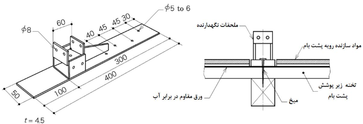
**الف - ظاهر****ب - سطح مقطع نصب****شکل ۴ - مثالی از ساختار سامانه ملحقات نگهدارنده**
