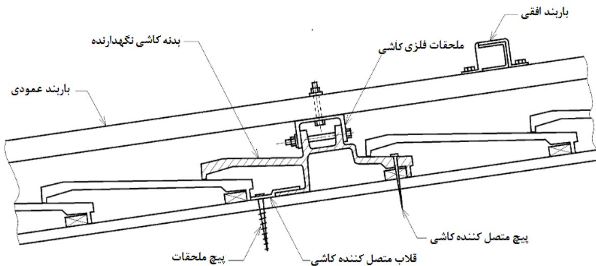
شکل ۵- مثالی از ساختار سامانه کاشی نگهدارنده
