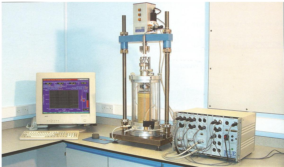
شکل ۳-۳- دستگاه کامل انجام آزمایش سه محوری
