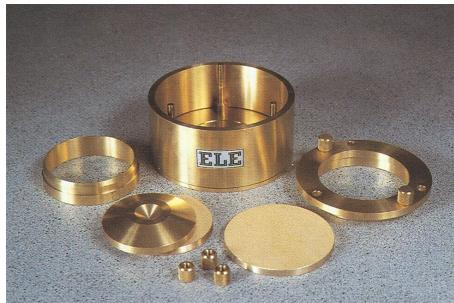
شکل ۴-۱- دستگاه انجام آزمایش تحکیم با قرائت الکترونیکی
