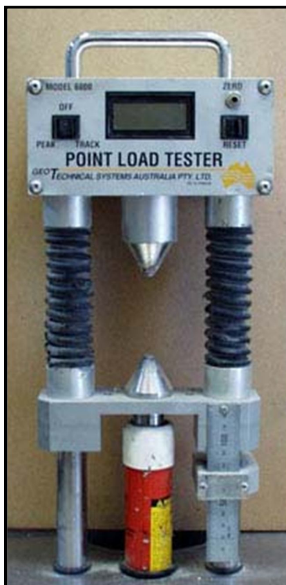
شکل ۲-۴- دستگاه قابل حمل بار نقطه‌ای
