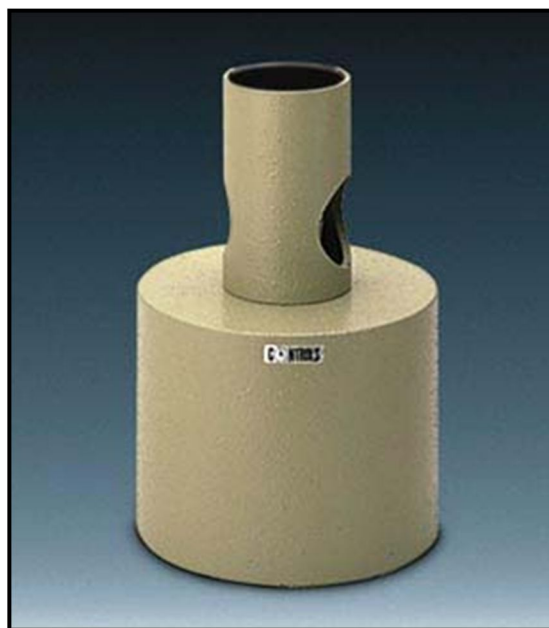
شکل ۲-۱۲- سندان فولادی واسنجی چکش اشمیت
