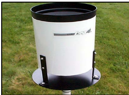
شکل ۲-۸- نمای بیرونی یک باران‌سنج ایستگاه خودکار
