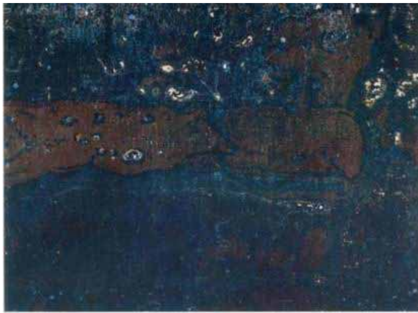
شکل ۱- تصویر زنگ زدگی درجه A
