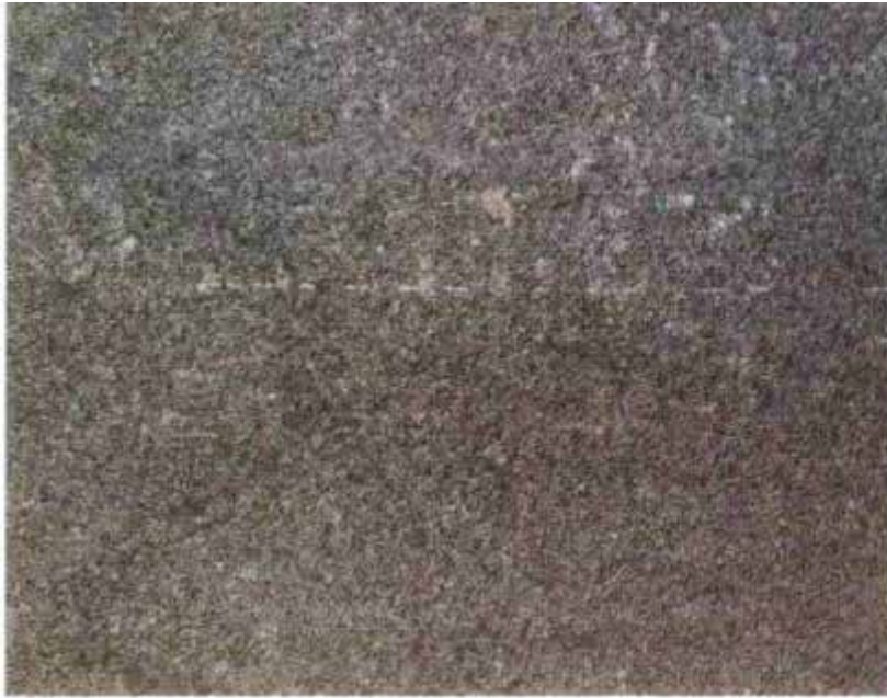
شکل ۲۵- تصویر درجه تمیزکاری با شعله AFL
