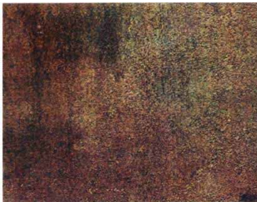
شکل ۲۱- تصویر درجه تمیزکاری دستی و ماشینی کامل CSt2
