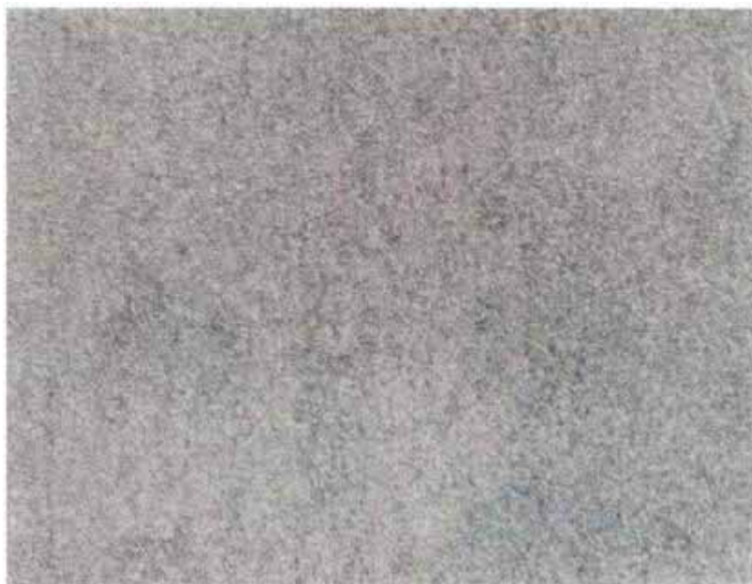
شکل ۱۳- تصویر درجه تمیزکاری پاششی خیلی کامل C Sa2 1 / 2
