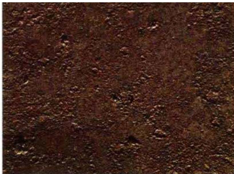
شکل ۱۵- تصویر درجه تمیزکاری پاششی سبک DSa1
