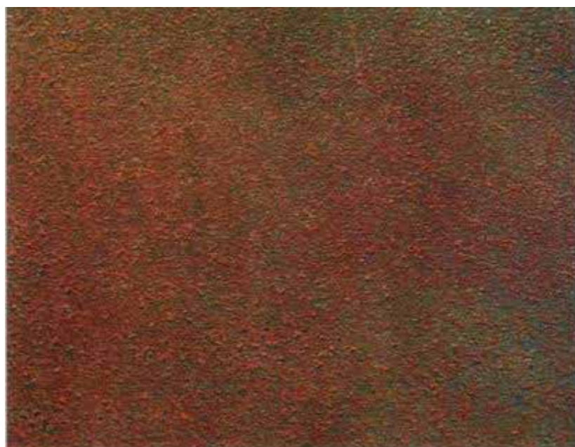
شکل ۱۱- تصویر درجه تمیزکاری پاششی سبک CSa1
