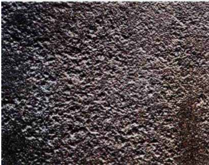
شکل ۲۸- تصویر درجه تمیزکاری با شعله DFL
