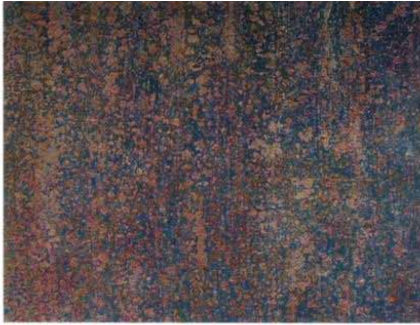
شکل ۷- تصویر درجه تمیزکاری پاششی سبک B Sa1
