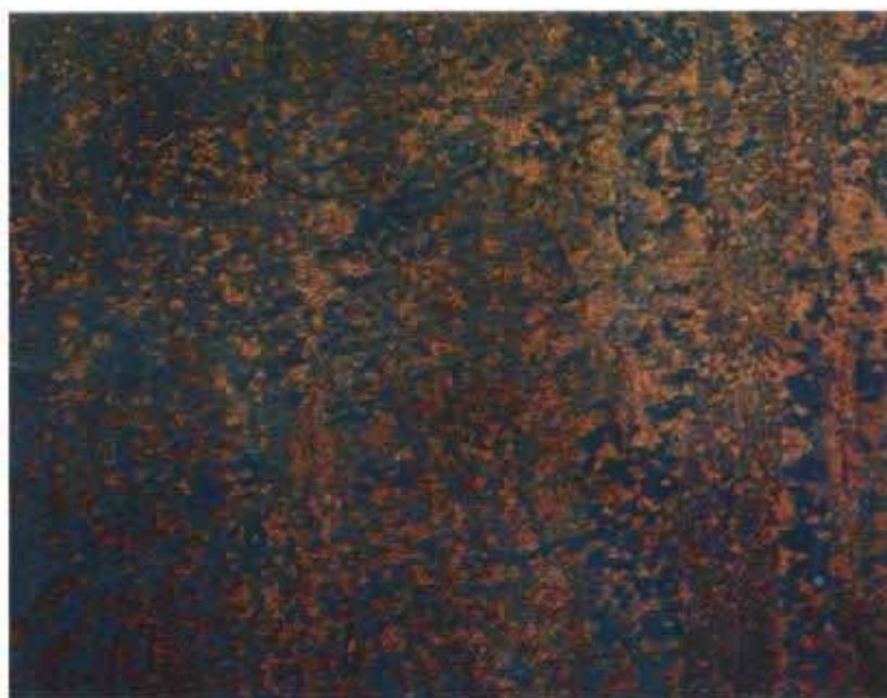
شکل ۱۹- تصویر درجه تمیزکاری دستی و ماشینی کامل BSt2
