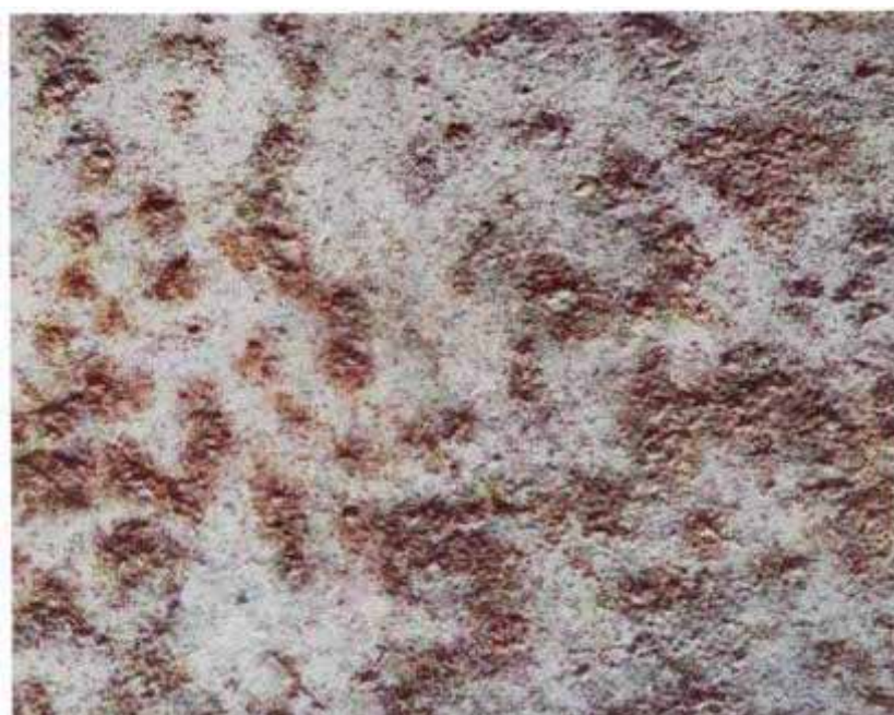
شکل ۱۶- تصویر درجه تمیزکاری پاششی کامل DSa2
