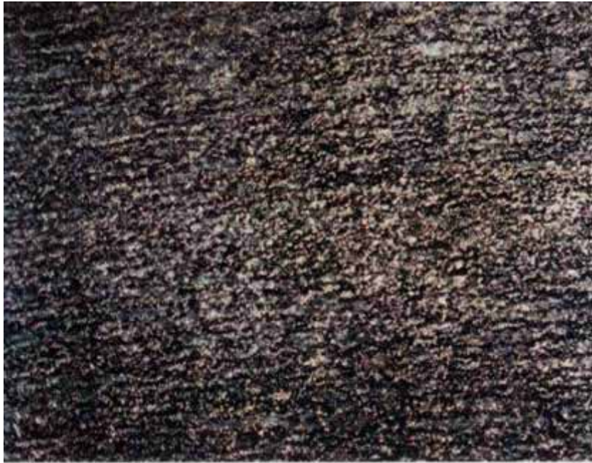
شکل ۲۷- تصویر درجه تمیزکاری با شعله CFL
