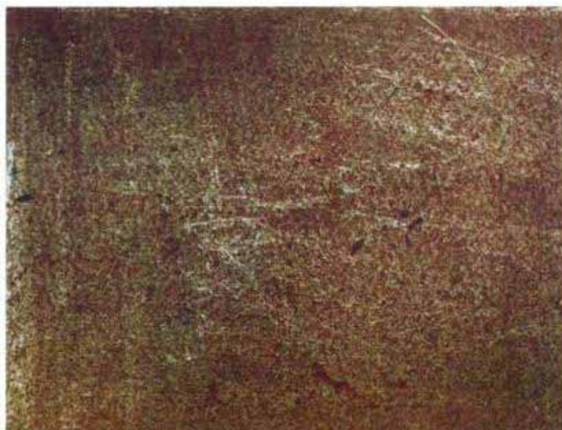
شکل ۲۲- تصویر درجه تمیزکاری دستی و ماشینی خیلی کامل CSt3
