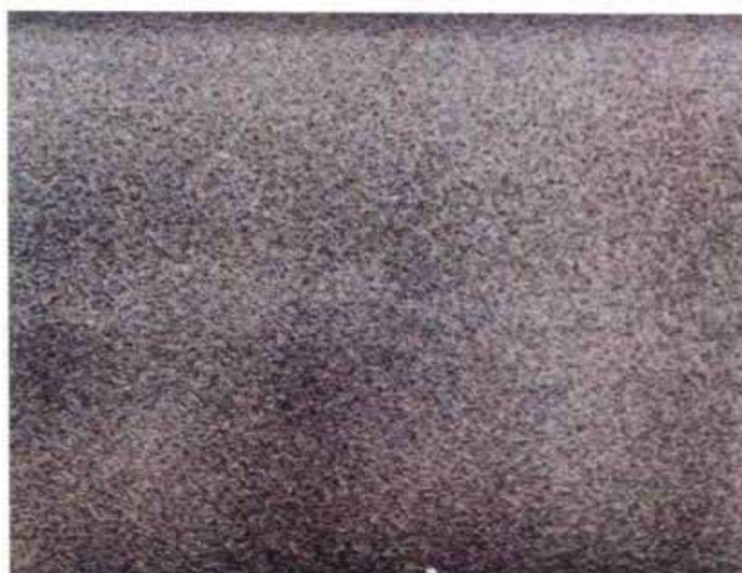
شکل ۱۲- تصویر درجه تمیزکاری پاششی کامل CSa2
