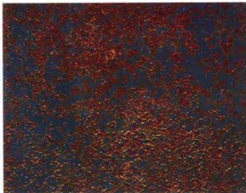
شکل ۲- تصویر زنگ زدگی درجه B
