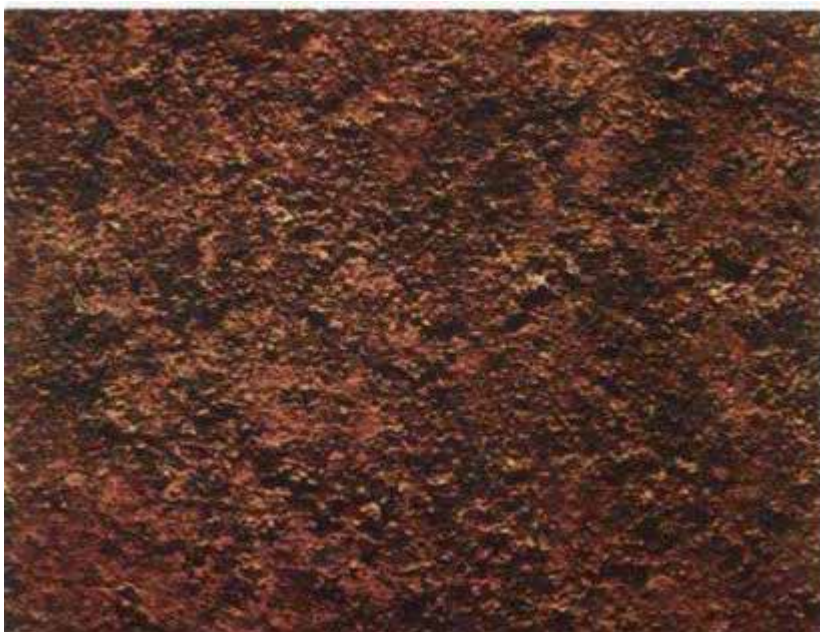
شکل ۴- تصویر زنگ زدگی درجه D
