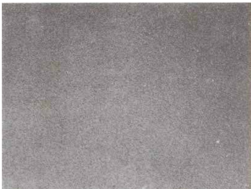
شکل ۶- تصویر درجه تمیزکاری پاششی به حد رنگ اصلی فولاد ASa3
