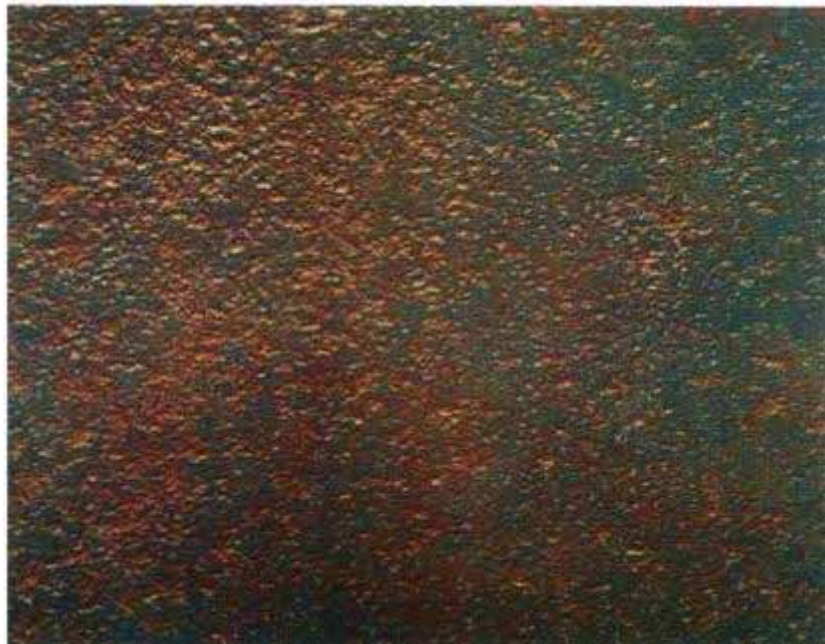
شکل ۲۴- تصویر درجه تمیزکاری دستی و ماشینی خیلی کامل DSt3
