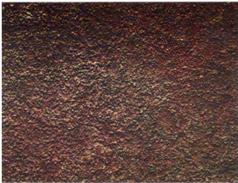
شکل ۳- تصویر زنگ زدگی درجه C
