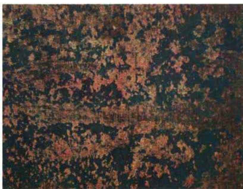
شکل ۲۰- تصویر درجه تمیزکاری دستی و ماشینی خیلی کامل BSt3
