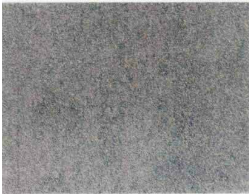
شکل ۵- تصویر درجه تمیزکاری پاششی خیلی کامل ASa2 \frac{1}{2}
