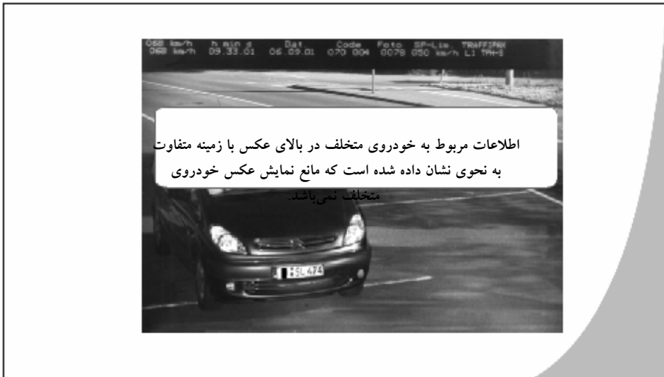
شکل ۸- نمایش مشخصات خودروی متخلف بر روی تصویر خودروی متخلف
