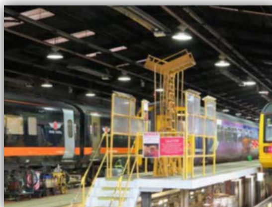
شکل ۲-۱۳- سکوی دسترسی به پانتوگراف همراه سیستم اینترلاکینگ
