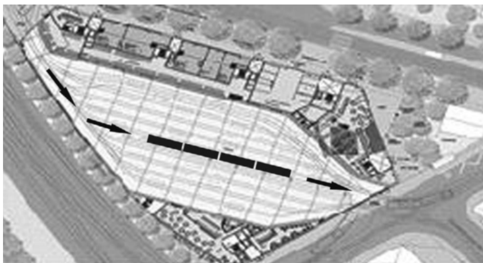
شکل ۳-۲- نمونه دپوی تراموا - ورود و خروج قطارها به خطوط پارکینگ از دو سمت مختلف انجام می‌شود.
