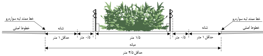
شکل ۴-۱۱- مشخصات هندسی میانه با حفاظ طولی انعطاف‌پذیر در آزادراه
