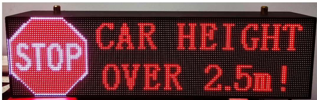
شکل ۱۸- تابلوی هشدار ارتفاع غیرمجاز
