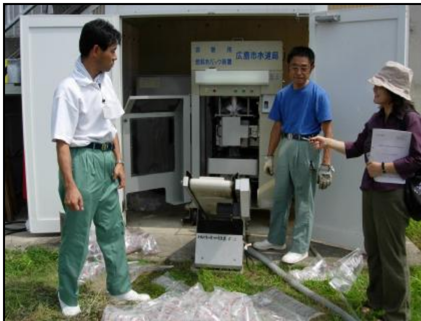
شکل 3-4- دستگاه بسته‌بندی آب اضطراری به صورت کیسه‌ای (عکس از تصفیه‌خانه آب شهر هیروشیما - ژاپن)
