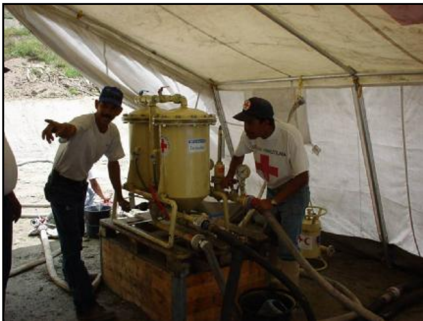
شکل 4-3- تصفیه و فیلتراسیون آب در سوانج جهت اسکان در اردوگاه موقت
