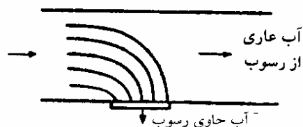
شکل ۸- پره‌های منحرف کننده در مسیر کانال انتقال آب
