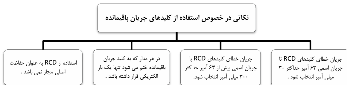
شکل ۵-۳- استفاده از کلیدهای جریان باقیمانده
