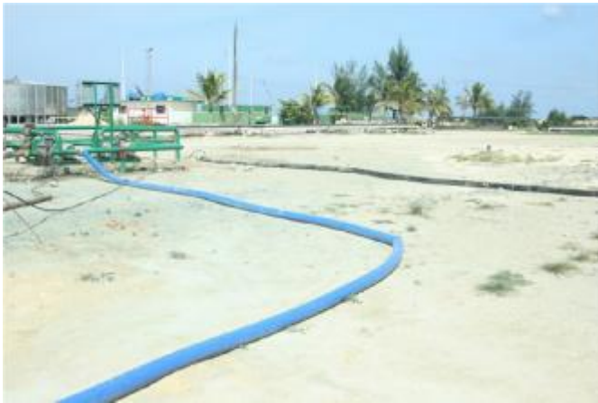
شکل ۳-۲: لوله های انعطاف پذیر collapsible
