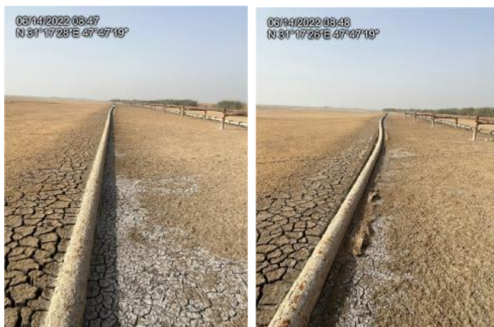
شکل ۲-۲۴: کمانش خطوط لوله فولادی عبوری از کف تالاب
