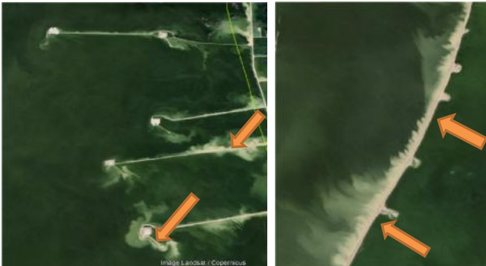
شکل ۲-۴: آبشستگی کناره جاده ها و تخریب لایه های جاده (فلش ها نشان دهنده محل آسیب است)
