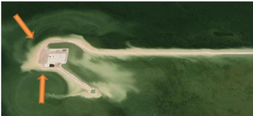
شکل ۲-۳۱: تخریب بدنه دایک گودال آتش و آبشستگی جداره جاده و دور محوطه (فلش ها نشان دهنده ی محل خرابی است)
