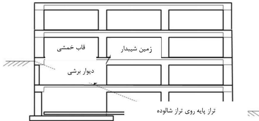
شکل ت-۴-۲۳: ساختمان با دیوار حائلی که به سیستم سازه‌ای متصل و پیوسته است.
