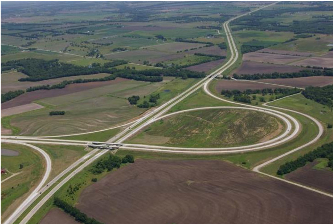
شکل ۶-۱۳- تبادلهای شیپوری آزادراه با آزادراه
