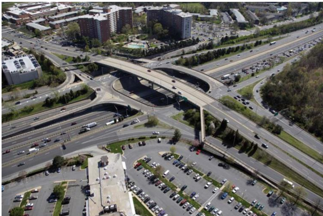
شکل ۶-۲۰- آزادراه با یک تبادل لوزوی سه طبقه
