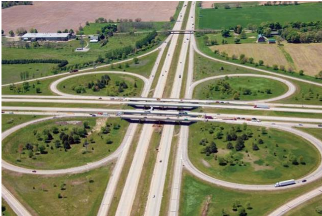
شکل ۶-۲۹- تبادلهای کامل با راههای جمع‌کننده-توزیع‌کننده
