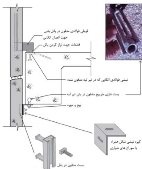
شکل ۱۰-۷- نمونه‌ای از اتصال دوخت به پشت
