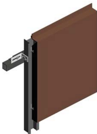
شکل ۸-۴- نمونه‌ای از روش اجرای هوک
