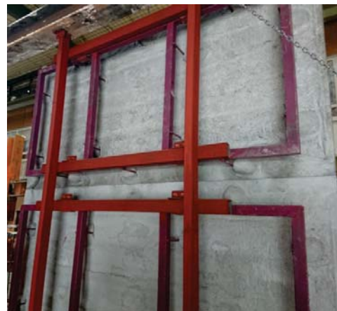
شکل ۱۱-۱۳- نمونه‌هایی از لایه پیوندی و مهارهای انعطاف پذیر
