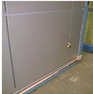
شکل ۳-۲- انجام آزمایش ضربه جسم سخت بر روی نما
