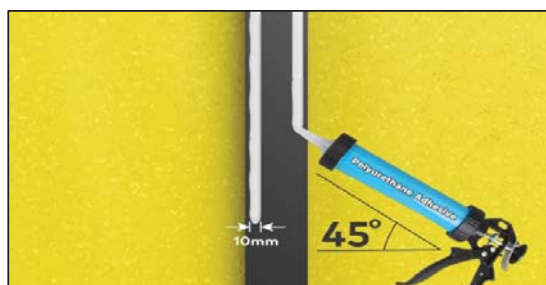
شکل ۷-۱۱- اجرای نواری از چسب پلی‌یورتان بر روی پروفیل قائم
