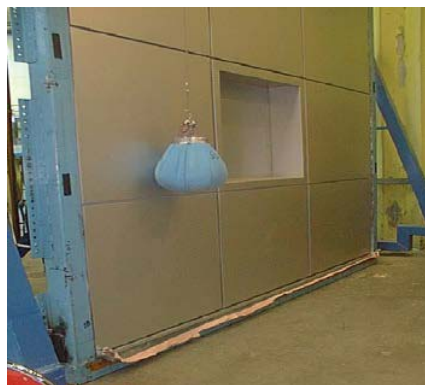
شکل ۳-۵- آزمايش ضربه جسم نرم سنگين روی نما
