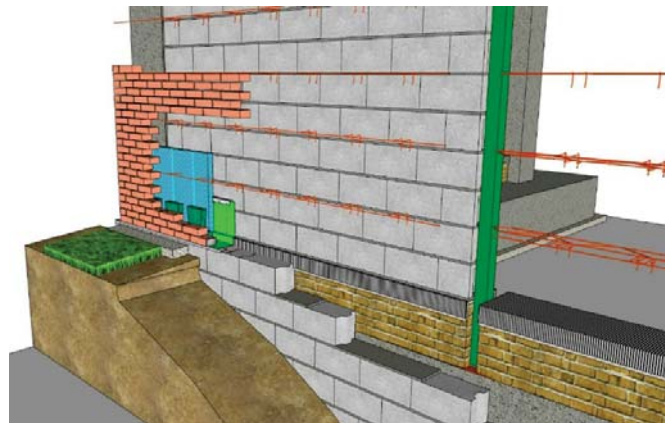
شکل ۵-۱- اجرای نمای آجری بر روی دیوار مسلح شده براساس ضوابط فصل دوازدهم
