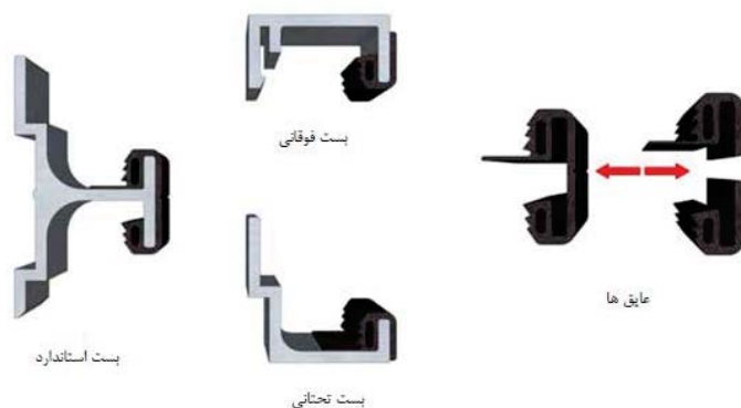
شکل ۷-۵- نصب درزپوش بر روی مهارها
