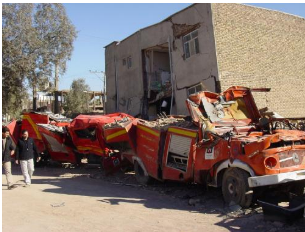
شکل ۲- تخریب ماشین های آتش نشانی در اثر فرو ریزش سازه نگهدارنده در زلزله بم
