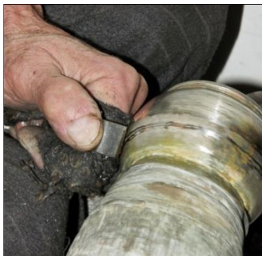
شکل ۱۱۲- تراشیدن لایه سطحی قطعه ورشو با استفاده از دستگاه چرخ کاری
