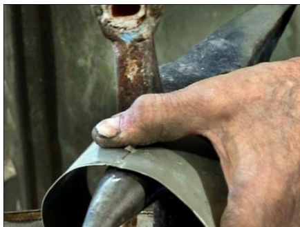
شکل ۸۵- اتصال موقتی لبه‌های چاک‌خورده ورق مخزن
