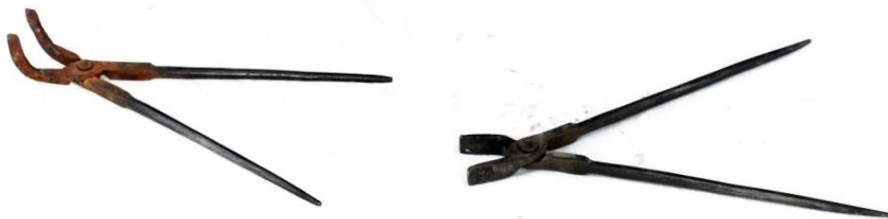
شکل ۴۸- دو نمونه انبر آتش کاری
