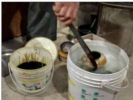
شکل ۱۰۹- شست و شوی قطعات آغشته به تیزاب سلطانی با استفاده از آب
