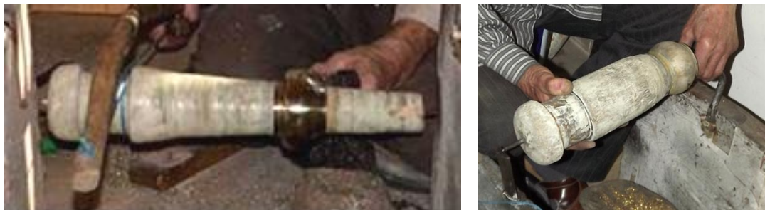
شکل ۶۱- دو نوع قالب چوبی خراطی‌شده برای استقرار محصول ورشو روی آن
