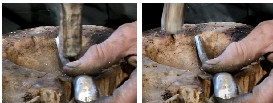
شکل ۱۰۵- شکل‌دهی به لولهٔ محصول با استفاده از چکش روی سندان چوبی
