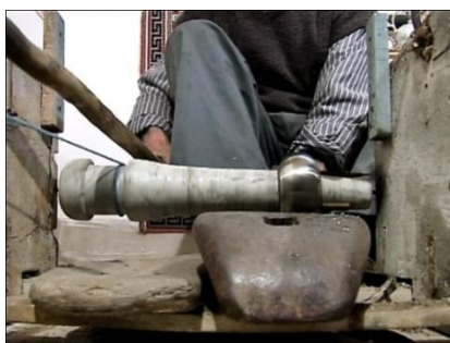
شکل ۱۱۱- چرخ کاری و براق کردن سطح قطعه ورشو
