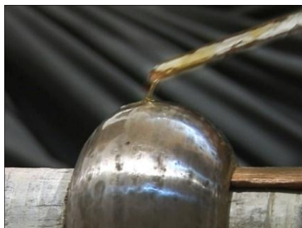
شکل ۱۱۳- آغشته کردن سطح قطعه ورشو برای دستیابی به سطح براق تر
