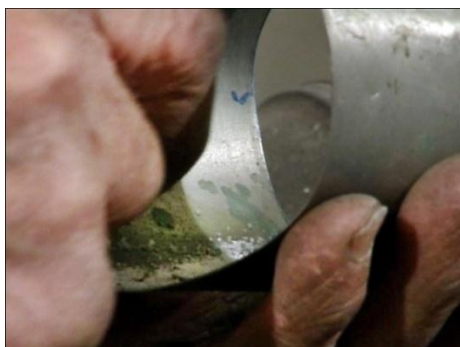
شکل ۸۷- ریختن تنکار روی درزهای داخلی ورق مخزن
