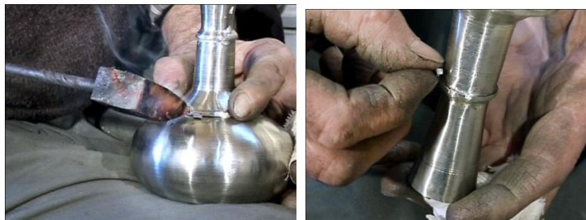
شکل ۱۱۵- وصل کردن گردن محصول به بخش بالایی مخزن به روش لحیم کاری
