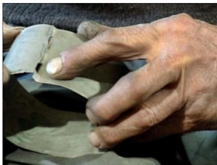
شکل ۸۴- درهم‌فروبردن دو لبه چاک‌خورده ورق مخزن
