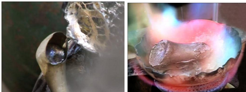
شکل ۱۰۴- پر کردن قطعهٔ لولهٔ محصول با سرب مذاب
