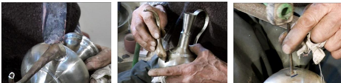
شکل ۱۱۸- سوراخ کردن بخش بالایی مخزن وصل کردن لولهٔ محصول روی آن
