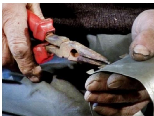
شکل ۸۳- داندانه‌ای کردن لبه‌های چاک‌خورده ورق مخزن
