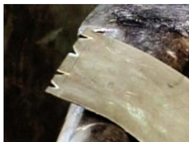
شکل ۸۱- ایجاد بریدگی روی لبه‌های ورق مخزن محصول
