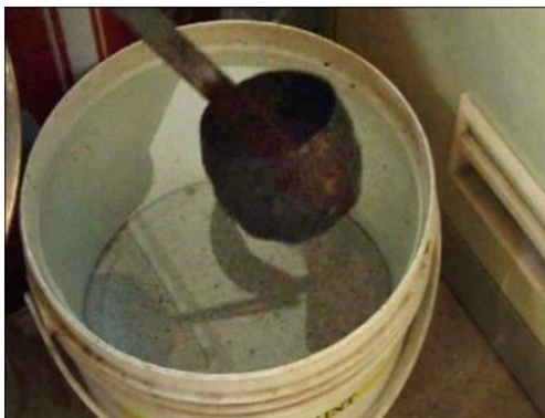
شکل ۹۴- خنک کردن قطعه مخزن در آب پس از گرمادهی
