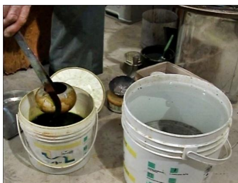
شکل ۱۰۸- تمیزکاری قطعات سیاه‌رنگ با استفاده از محلول تیزاب سلطانی و آب
