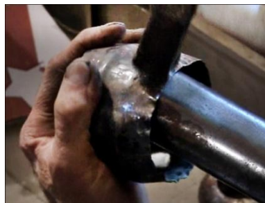
شکل ۹۲- چکش کاری اولیه قطعه مخزن
