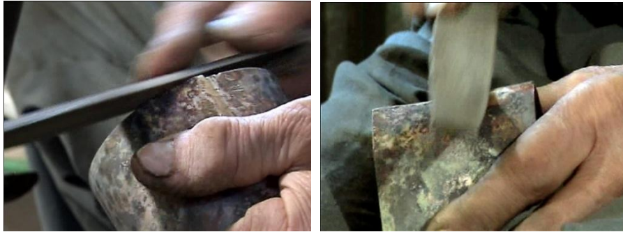
شکل ۹۰- برطرف کردن ناهمواری درزهای جوش خورده و بریدگی‌های زاید لبه‌ها با سوهان
