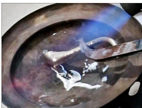
شکل ۱۰۶- خارج کردن سرب از درون لولهٔ محصول با استفاده از حرارت مستقیم
