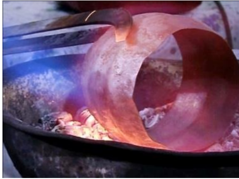
شکل ۹۳- گرماکردن قطعه برای جلوگیری از شکستن اتصالات
