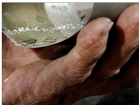
شکل ۸۶- استقرار قطعات قلع روی درزهای داخلی ورق مخزن
