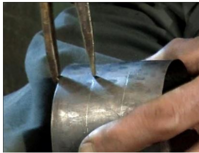
شکل ۹۱- رسم محدوده چکش کاری روی قطعه مخزن
