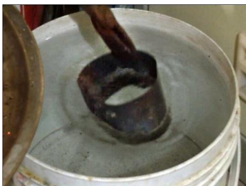
شکل ۸۹- خنک کردن قطعه مخزن در آب پس از گرمادهی
