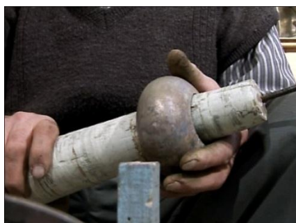
شکل ۱۱۰- استقرار قطعه ورشو بر روی میله چوبی دستگاه چرخ کاری
