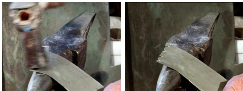
شکل ۸۲- چکش کاری ورق برش‌خورده برای ساخت شکل اولیه مخزن محصول
