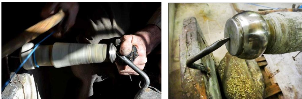
شکل ۶۲- محل استقرار محصول ورشو در دستگاه چرخ کاری
