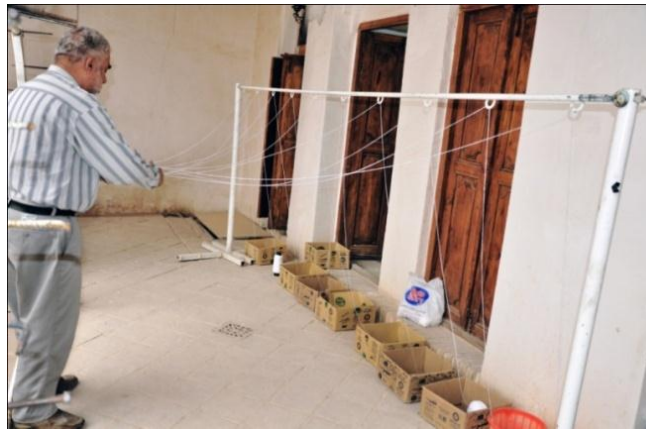
شکل ۶۵- قراردادن سر نخ‌ها در دست برای تعیین زیر و روی آنها به کمک انگشتان دست
