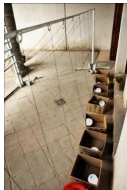
شکل ۶۴ - استقرار نخ‌ها روی میله نگه‌دارنده نخ‌های چله‌دوانی
