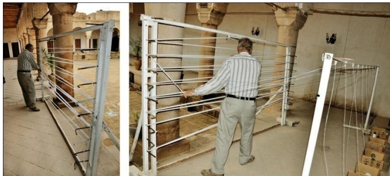
شکل ۵۳- حرکت نخ‌های تار از میله‌های قسمت قلب در پایین به سمت بالا
