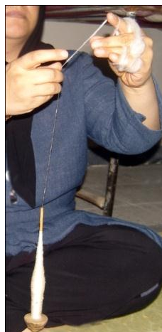
شکل ۶۱- بازکردن الیاف ابریشم از روی فتیله و تبدیل آنها به نخ
