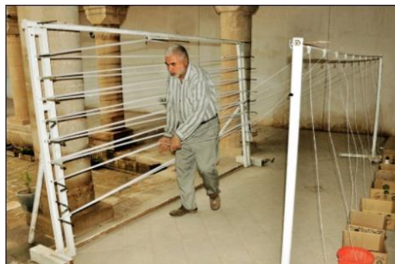
شکل ۷۶- همراهی دست برای جلوگیری از گم‌شدن مسیر چله‌دوانی
