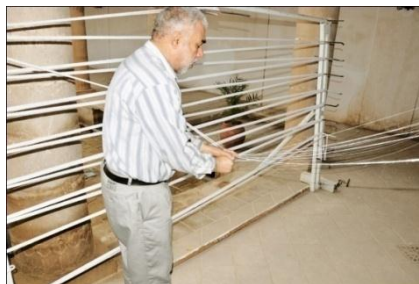
شکل ۷۱- زیر و رو کردن مجدد نخ‌ها با استفاده از انگشتان پس از پایان هر دور
