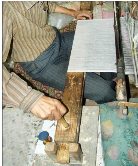
شکل ۸۶- ثابت کردن نورد با استفاده از مل پیچ
