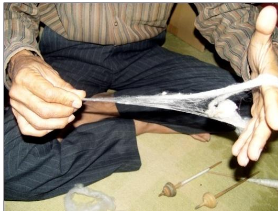
شکل ۵۸ - تولید نخ اولیه با پیچش و کشش الیاف ابریشم
