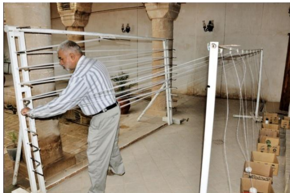
شکل ۶۸- رفت و آمد مداوم چله‌دوان از بالا به پایین، در بین دو ستون دار چله‌دوانی
