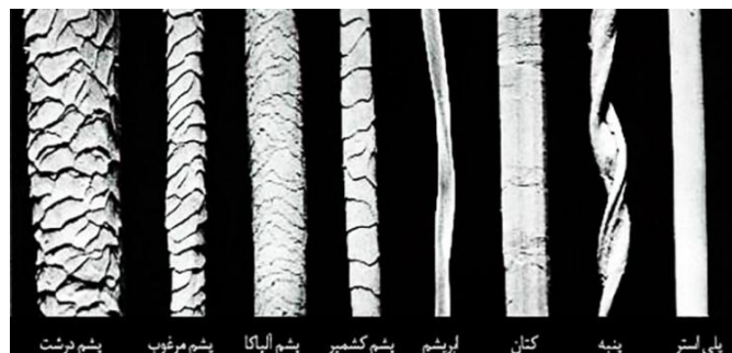
شکل ۵- مقایسه الیاف ابریشم با سایر الیاف طبیعی (تصویر میکروسکوپی)
