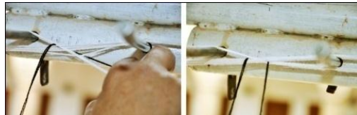
شکل ۷۵- گره‌زدن گروه نخ‌های زیر و رو در محل میله‌های تفکیک‌کننده برای مشتی
