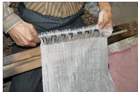
شکل ۸۹- استقرار ادامه منسوج ابریشم روی نورد با استفاده از میله نگه دارنده نخ های تار
