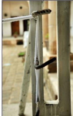
شکل ۷۰- شیوه استقرار نخ‌های تار روی میله‌های قلب (نمای روبه‌رو)
