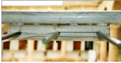
شکل ۶۷- جایگزینی میله‌های تفکیک‌کننده نخ‌های تار بالایی و پایینی با انگشتان
