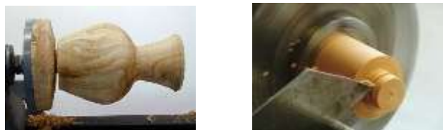
شکل ۳۶- شیوه کار با ابزار جداکننده استاندارد
