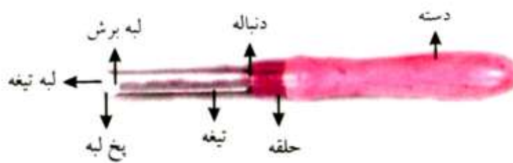
شکل ۲۲- اجزای ابزار برش و تراش خراطی چوب
