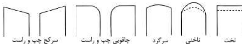
شکل ۳۴- انواع نوک تیغه در اسکنه‌ها
