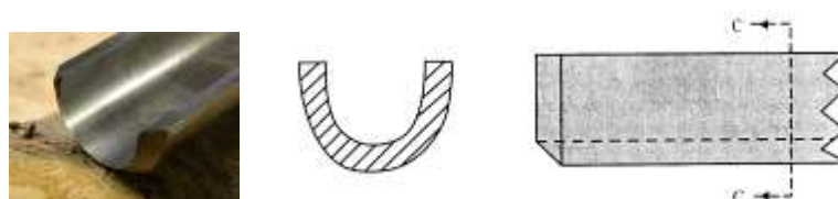
شکل ۲۶- مقطع نوک تیغه ابزار نون‌گاز اندام
