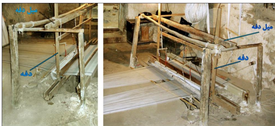
شکل ۲۶- موقعیت استقرار میل دفه در دستگاه احرامی بافی
