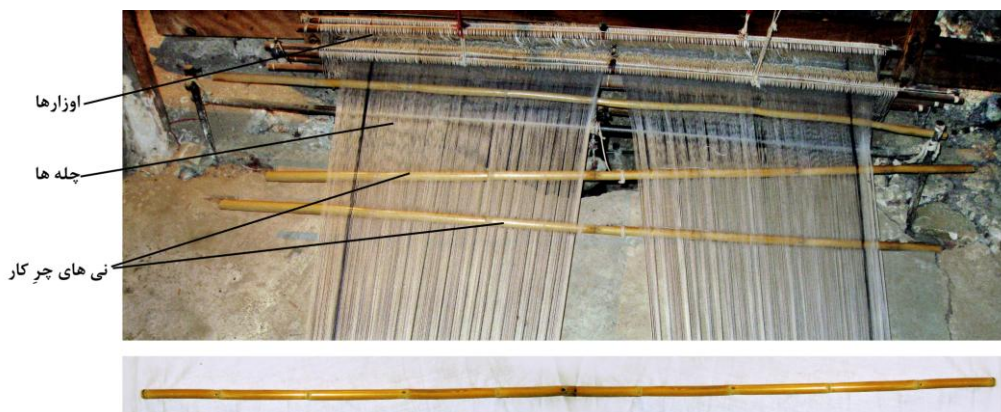
شکل ۴۵- نمای بالا و روبه‌رو از موقعیت نی‌های چر کار در دستگاه احرامی‌بافی
