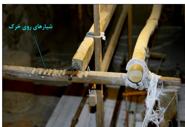
شکل ۲۵- شیارهای سطح بالایی خرک برای تنظیم فاصله دفه
