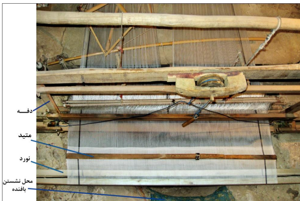
شکل ۴۹- موقعیت متید در دستگاه احرامی بافی
