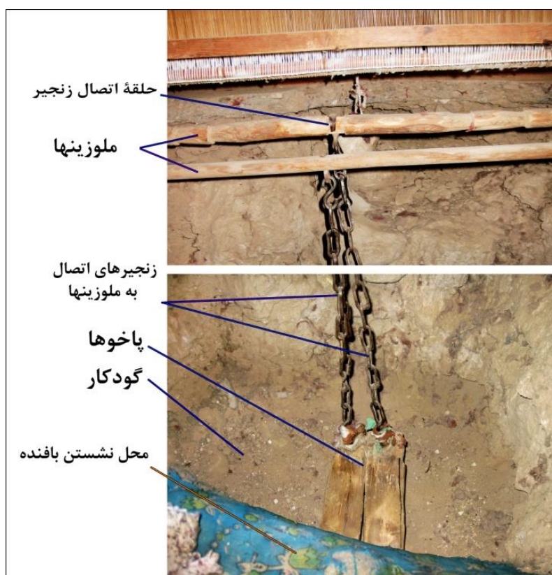
شکل ۴۴- موقعیت پاخوها و ملوزینها در دستگاه احرامی بافی
