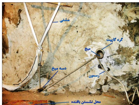
شکل ۵۰- موقعیت میخ، رسمون و دسه‌میخ
