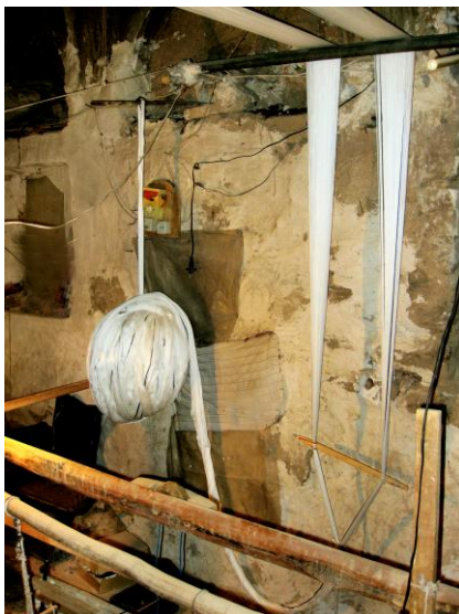
شکل ۲- موقعیت گندل در دستگاه احرامی بافی
