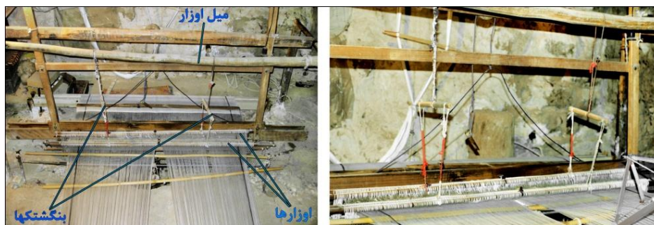
شکل ۲۷- موقعیت استقرار میل اوزار در دستگاه احرامی بافی
