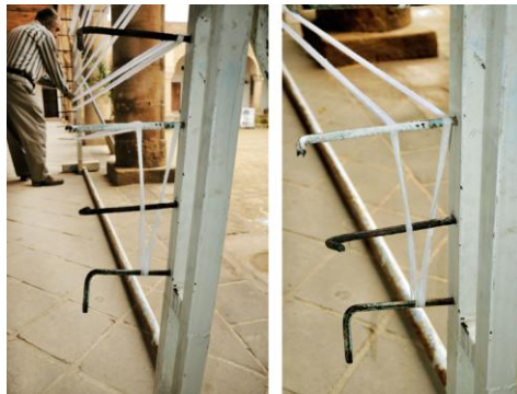
شکل ۱۸- موقعیت میله‌های سه‌گانه بخش قلب بر روی ریل خط و شیوه استقرار چله‌ها بر روی آنها
