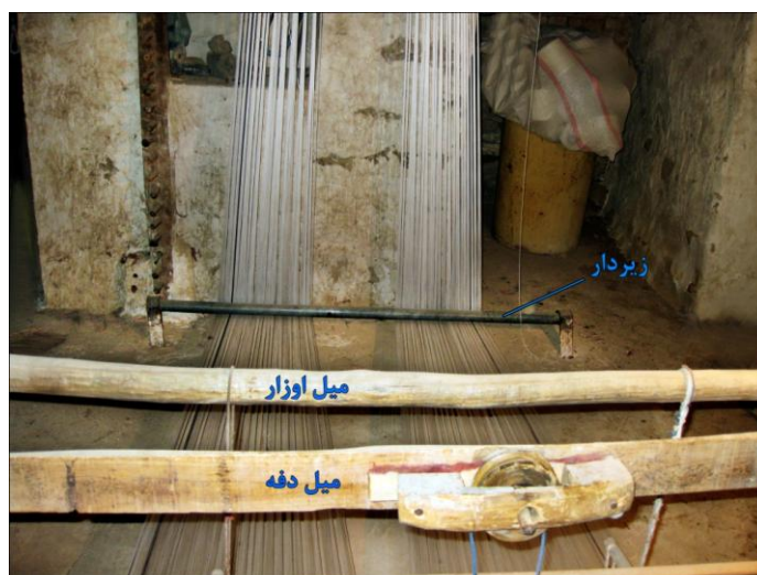
شکل ۲۸- موقعیت استقرار زیردار در دستگاه احرامی بافی
