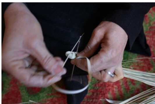
شکل ۳۴- عبوردادن دنباله نوار پیش از درون سوزن کپوبافی
