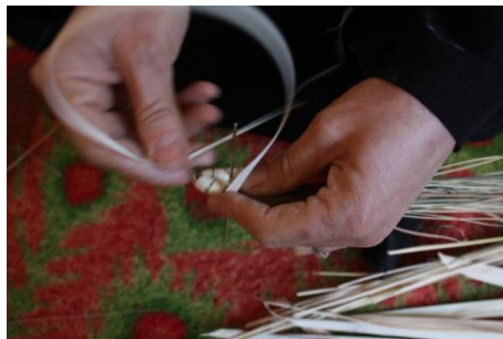
شکل ۱۳- عبور دادن نوار پیش از سوراخ سوزن کپوبافی
