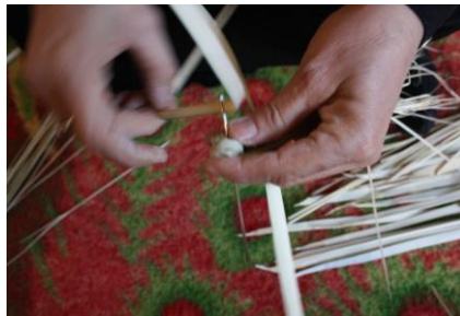
شکل ۱۹- عبور سوزن کپوبافی از میان گره ایجادشده
