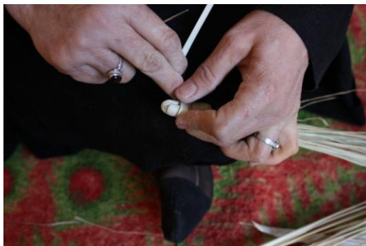
شکل ۳۳- پیچاندن پیش به دور رج های اول و دوم کپو بدون استفاده از سوزن کپوبافی
