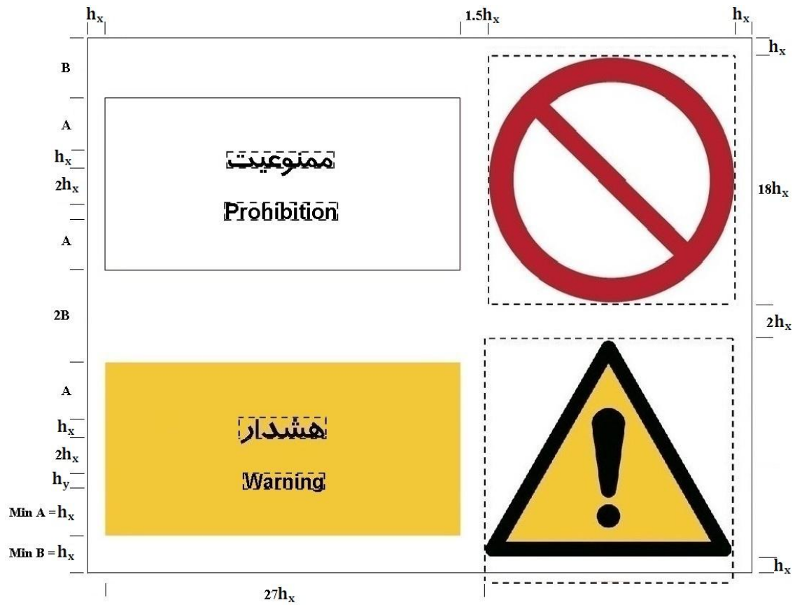
شکل ۱۹- تابلوی ترکیبی افقی چندگانه
