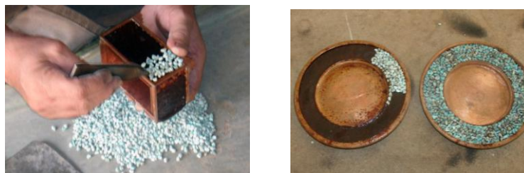
شکل ۴- نشاندن سنگ فیروزه بر روی زیر ساخت
