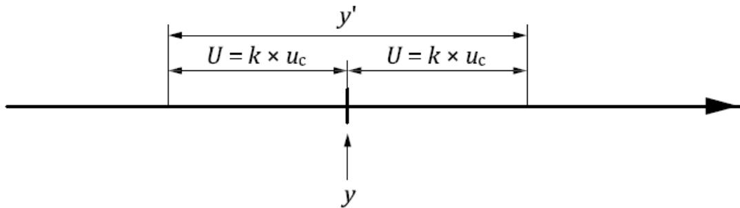
شکل ۴ – نتیجه اندازه‌گیری،  $y$ ، و نتیجه اندازه‌گیری کامل،  $y'$
