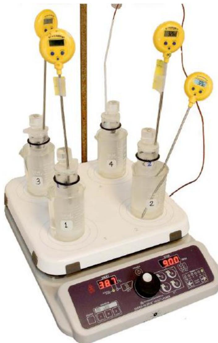
شکل ب-۱-۱ دستگاه آزمون خوردگی تسریع شده آهن ۴ مکانی
