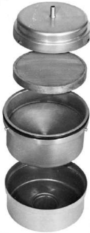
شکل ۱- محفظه تراوش تحت فشار A
