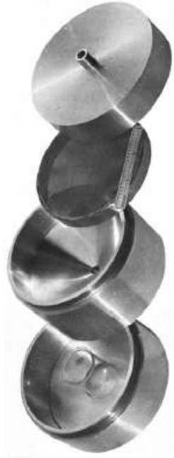
شکل ۳- محفظه تراوش تحت فشار B
