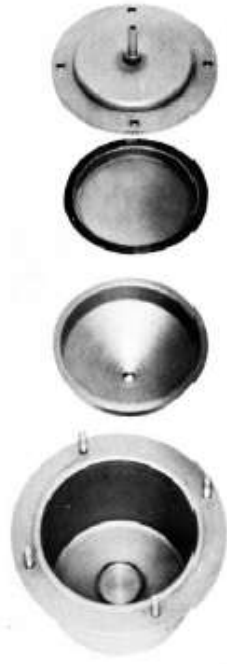
شکل ۴- محفظه تراوش تحت فشار C
